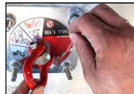
**8.** Installez l'anneau et insérez la goupille de sécurité. Vous pouvez inscrire au marqueur ou ajouter une étiquette sur le HAP 1.15 avec la date de l'application de la charge d'essai, le nom de la personne qui a effectué l'essai, etc.
