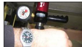
6. Vérifiez la charge sur le HAT 28 après 5 minutes (aiguille noire) et notez la différence entre cette valeur et la charge d'essai appliquée initialement (aiguille rouge).
