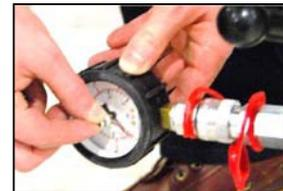
4. Tenez le HAT 28 par la poignée tout en augmentant la charge sur le HAP 1.15 en tournant la manivelle dans le sens horaire. Augmentez la charge jusqu'à la charge d'essai de 26,5 kN soit atteinte.
