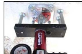
Tournez la manivelle dans le sens horaire jusqu'à ce que les quatre pattes soient en contact avec le matériau-support.
