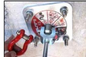
2. Raccordez le HAT 28 avec le boulon adaptateur à anneau et positionnez l'appareil de telle manière que les bords de sa plaque de fixation soient parallèles aux bords de la plaque du HAP.
