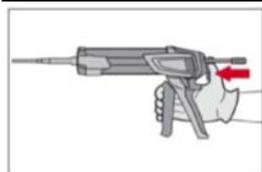
Après l'injection, dépressuriser la pince en pressant le bouton de verrouillage. Cela permettra d'éviter de continuer à injecter de la résine.
