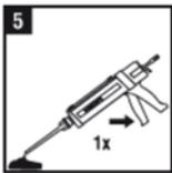
La cartouche s'ouvre automatiquement lors de l'application. Ne jamais percer activement l'emballage – cela causerait une défaillance du système !
