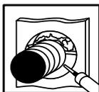
**Appliquer CFS-S ACR à l'aide d'un pistolet d'injection:** Le mastic CFS-S ACR adhère à la plupart des substrats (béton, maçonnerie, voiles, plâtre, etc.) sans utiliser de couche primaire. Pour améliorer l'adhésion sur les substrats poreux, utiliser du mastic CFS-S ACR dilué dans l'eau comme couche primaire. D'autres couches primaires ne sont pas nécessaires.
