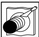
Lisser le joint avec de l'eau, en utilisant une spatule étroite ou un doigt.
