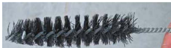
Figure 8: Les écouvillons sont rarement utilisés sur les chantiers. Dans ce cas un écouvillon a été utilisé mais son efficacité n'est pas optimum vu sa vétusté. Les critères sur la vétusté des accessoires ne sont pas disponibles dans les instructions sur les chantiers.
